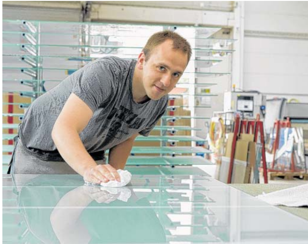
Schaut immer ganz genau hin: Bevor Daniel Rahe diese fertig gestrahlte und gebohrte Ganzglastür versiegelt, überprüft er jedes Detail. Selbst kleinste Material- oder Produktionsfehler entgehen ihm nur selten.
